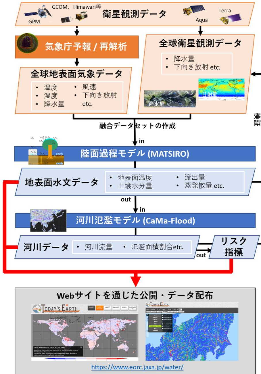
図 2-1 TE-Japan の計算フロー概念図
