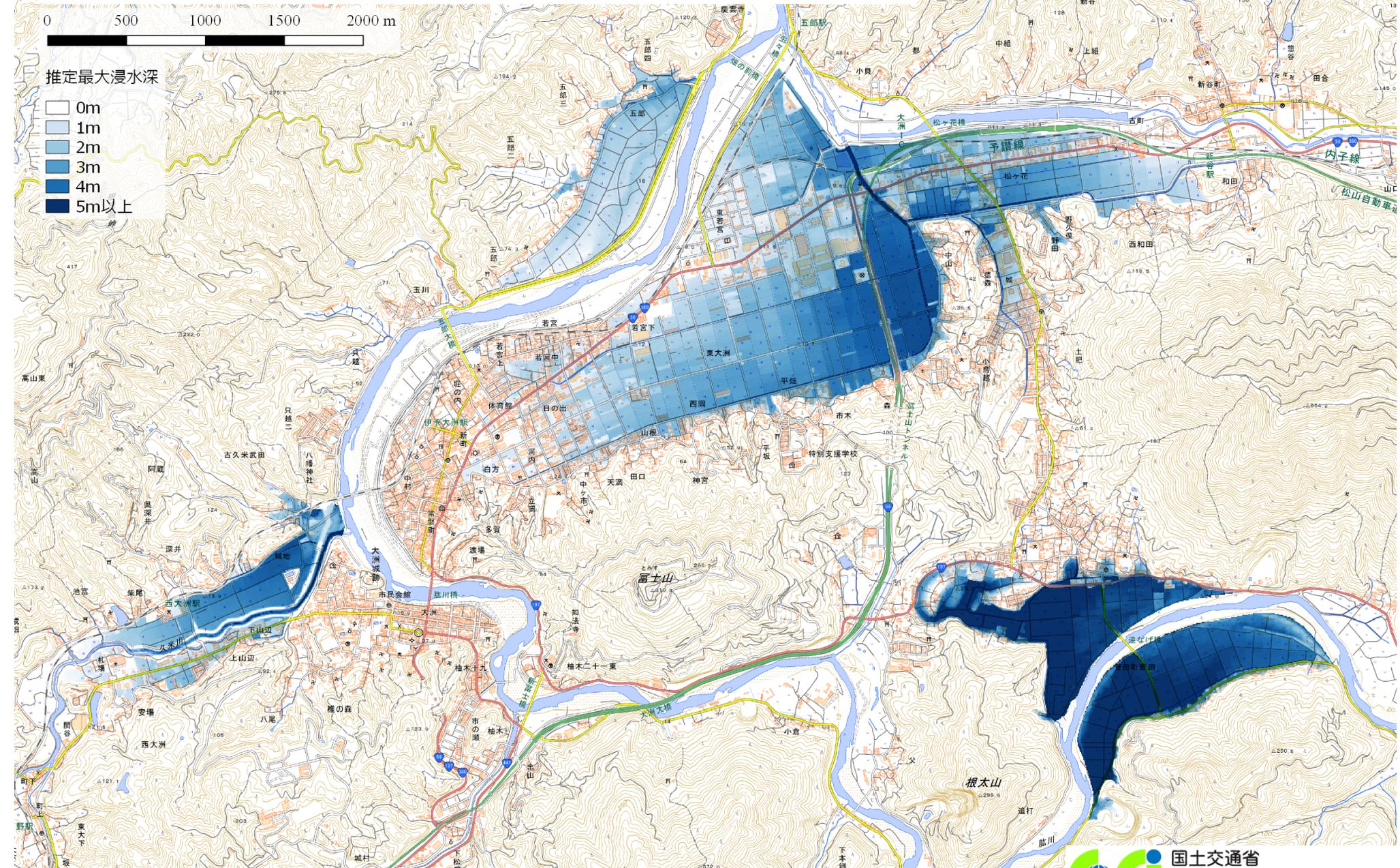
この地図は、7月7日の映像等の情報から浸水した範囲の端の地点を確認し、その地点の高さから標高データを用いて浸水面を推定し、浸水面から水深を算出し深さごとに色別に表示しています。実際に浸水のあった範囲でも把握できていない部分、浸水していない範囲でも浸水範囲として表示されている部分があります。
