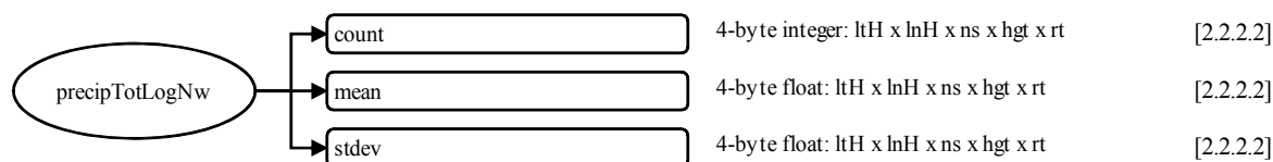
図 2.1-16 3CMBのデータフォーマット構造, G2, precipTotLogNw
