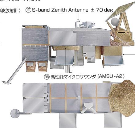
⑳ 高性能マイクロサウンド (AMSU-A1) ㉑ パーツA ㉒ 雲・地表放射エネルギー測定センサ (CERES)
