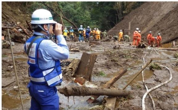
関係機関合同による土砂崩れ箇所の調査 (レーザー計測器を活用) (神奈川県相模原市)
