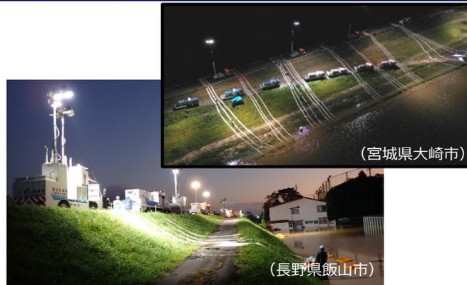
排水ポンプ車による24時間体制の緊急排水状況
