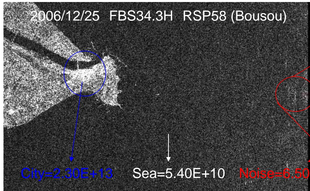
画像端で衛星進行方向に線状雜音が見られることがある。
