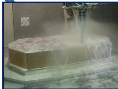
試作中の大型主鏡
