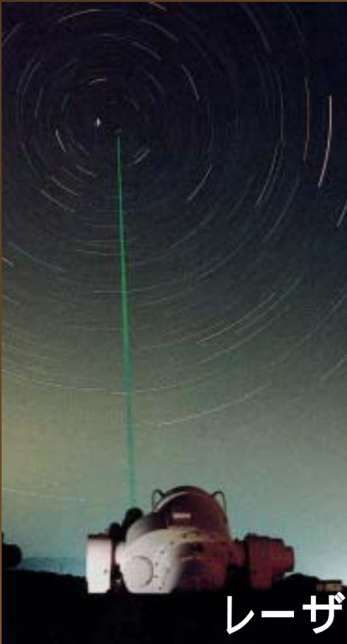
レーザー測距装置で衛星の位置を観測
